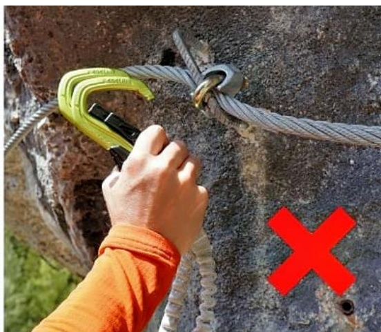
Prehodi mimo sider, varen ter nevaren način prepenjanja Foto Mijo Kovačević
