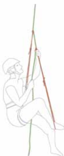
Slika 2a: Vzpenjanje s trakovi oz. z vrvicami.
