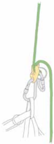
Slika 3a: Vzpenjanje s sistemom avtoblok in polovičnim škripcem.
