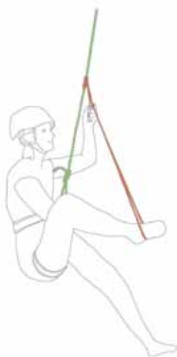
Slika 4a: Dvig iz visečega položaja.
